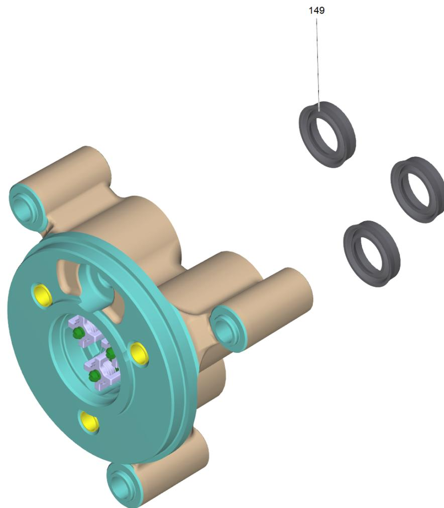
10 Головка цилиндра комплектный MS/TK37 (4.550-019.0)
